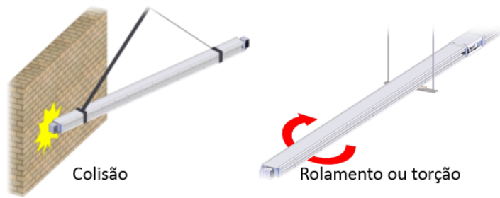
Figura 1: Representação esquemática de movimentação incorreta de barramentos blindados através de cintas ou soltos.
